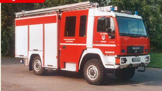
Die erste Generation der Hessen-LF 10/6 baute Iveco Magirus auf MAN-Fahrgestellen vom Typ LE 10.180 mit Allradantrieb und Einzelbereifung. Auf der Mannschaftskabine prangt der Schriftzug „Katastrophenschutz Land Hessen“. Hier zu sehen das Fahrzeug der FF Bischofsheim.
