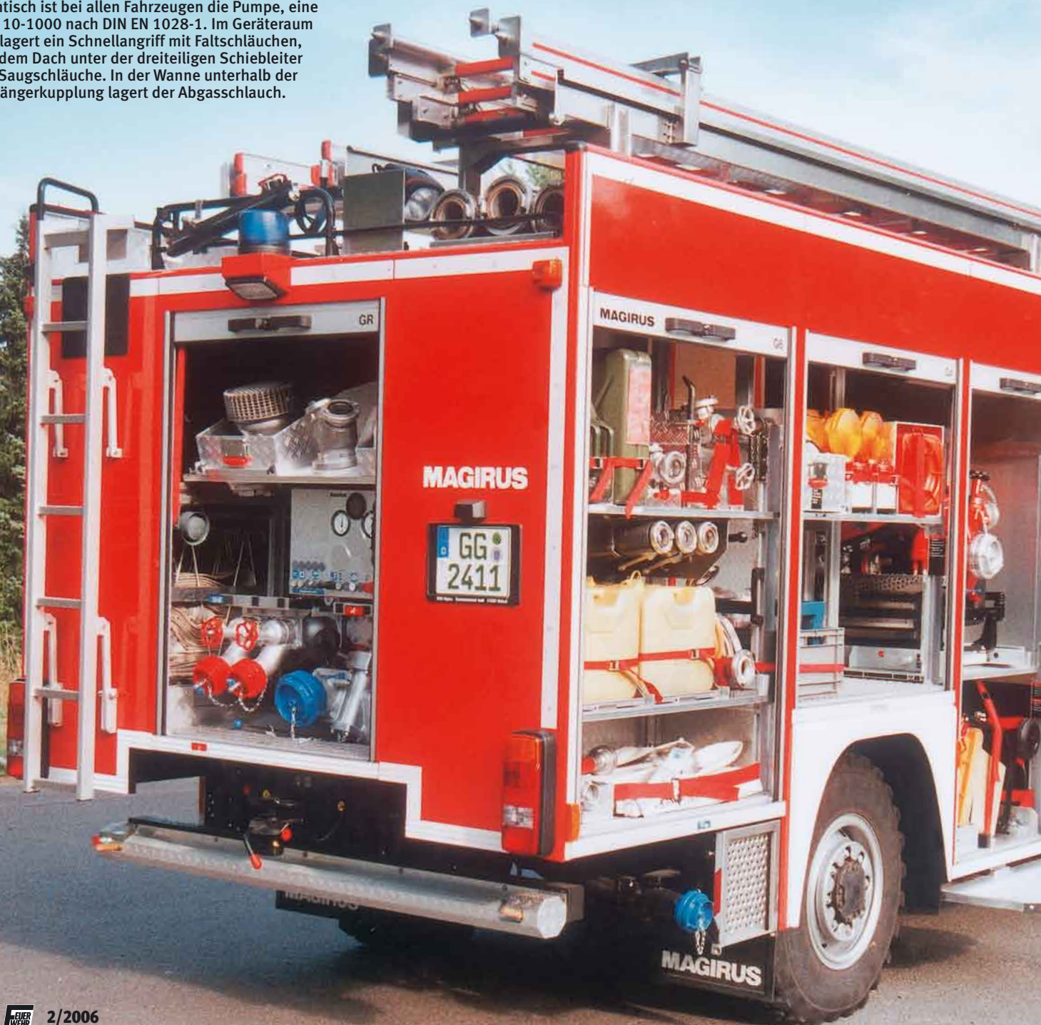
Die erste Generation der Hessen-LF 10/6 baute Iveco Magirus auf MAN-Fahrgestellen vom Typ LE 10.180 mit Allradantrieb und Einzelbereifung. Auf der Mannschaftskabine prangt der Schriftzug „Katastrophenschutz Land Hessen“. Hier zu sehen das Fahrzeug der FF Bischofsheim.
