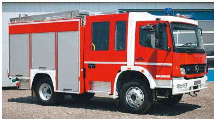
In der zweiten Auslieferung erhielten die LF 10/6 Fahrgestelle von Mercedes. Die Atego 918 haben eine Motorleistung von 130 kW, sind 7020 mm lang, 2500 mm breit und 3300 mm hoch. Radstand 3690 mm. 31 Einheiten sind ausgeliefert worden.
