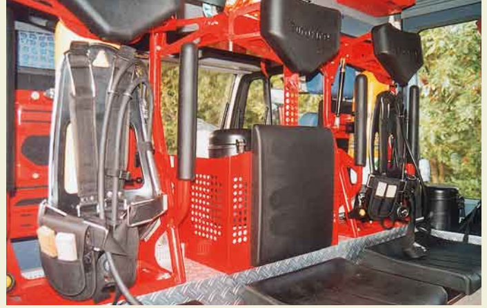
Zwei der vier Pressluftatmer sind in der Mannschaftskabine untergebracht. Sie können während der Anfahrt vom Angriffstrupp angelegt werden. Der Mittelplatz sorgt dafür, dass sich die Truppmänner dabei nicht ins Gehege kommen.
