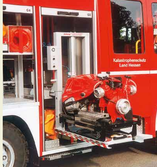
Die Tragkraftspritze bringt ein pneumatisch absenkbarer Schlitten auf eine günstige Entnahmehöhe. Wichtig bei solch hohen Allradfahrzeugen. Darunter lagert ein Wassersauger.
