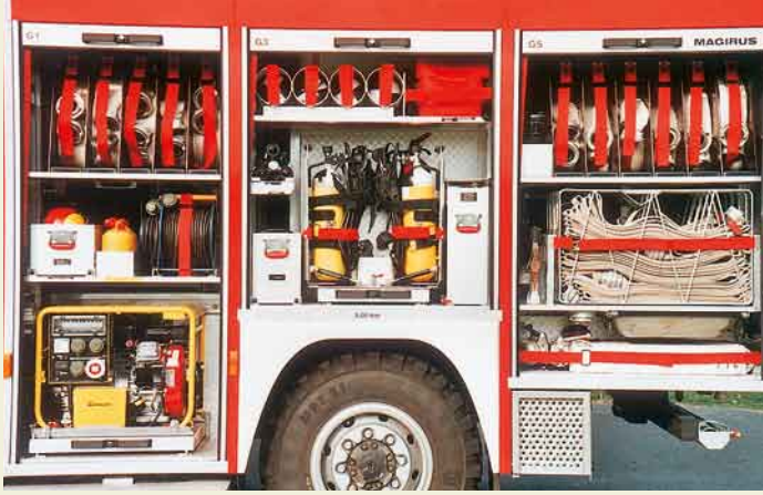
Auf der linken Seite ist beim Bischofsheimer LF 10/6 der Stromerzeuger untergebracht. In G 3 befinden sich die beiden anderen Pressluftatmer mit den Reserveflaschen. Ansonsten wird diese Fahrzeugseite von Schläuchen beherrscht.
